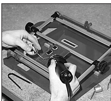
Removendo excesso de solda com ar quente e trança de soldar
