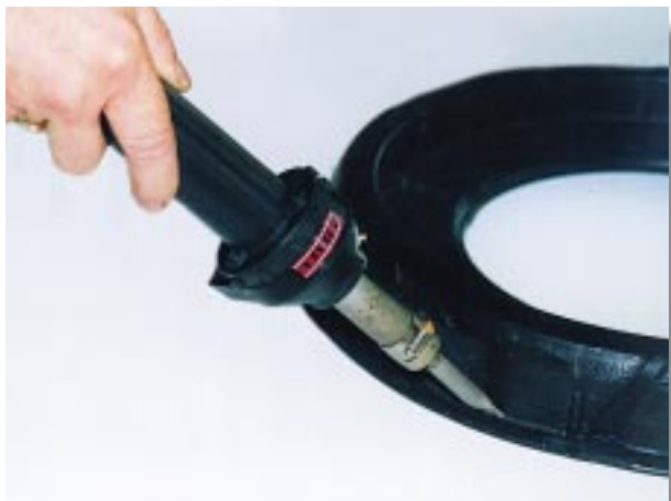
Utilização da HOT-JET S num bordo em PE-HD.
