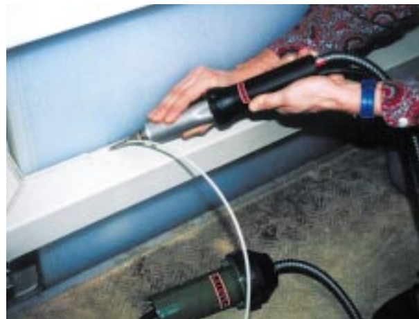
LEISTER Diode PID com tubo de adaptação com protecção térmica. Suprimento de ar com um soprador MINOR.
