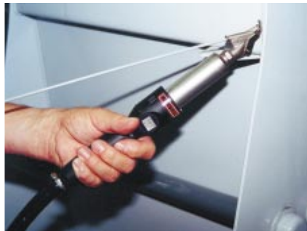
Soldador PEN R com visor digital para os valores SET e ACTUAL. A ferramenta de soldagem potente.
