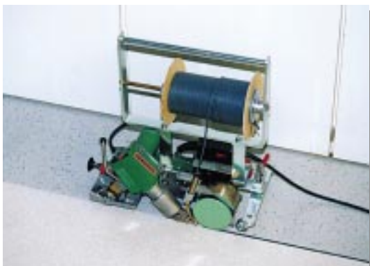
Universal a soldar pavimento de PVC-P Velocidade de soldagem 4 - 5 m/ min.
