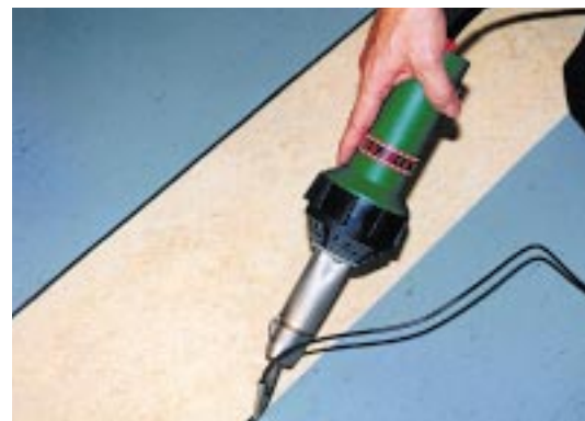
Ferramenta de soldagem manual TRIAC S equipado com terminal de soldagem rápido.
