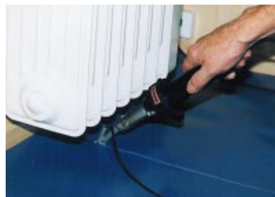
Ferramenta de soldagem manual Hot Jet S, com terminal de soldagem rápida. Apenas com 580 g de peso, a ferramenta manual é apropriada para soldagens em locais de difícil acesso.
