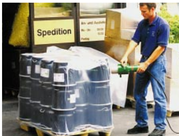
Empacotamento de paletes e objectos volumosos com a FORTE S3 para transporte. Possibilidade de Trabalho em compartimentos fechados.
